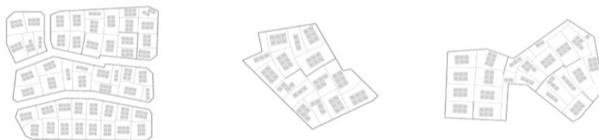
[그림 3-10] 유전 알고리즘 기반 필지 적응형 건물 배치 최적화 시스템 산출물
