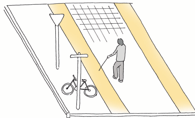
▲ 장애물구역+유도 및 경고용 띠+보행안전구역+유도 및 경고용 띠
