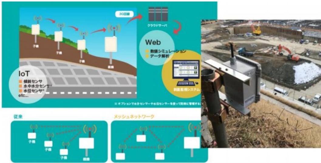
〈부도 2-18〉 경사측정 방식의 메시(mesh) 네트워크 기반 급경사지 계측시스템
