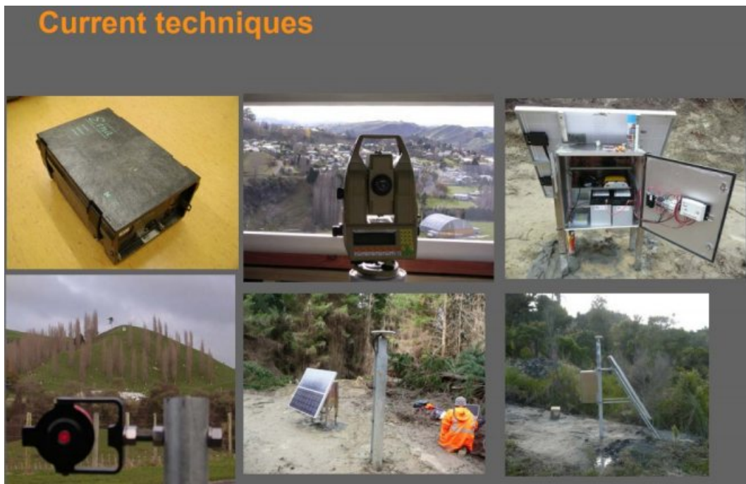
〈부도 2-31〉 지진가속도계, 토털스테이션, 전원공급장치, 영상계측, 강우량계
