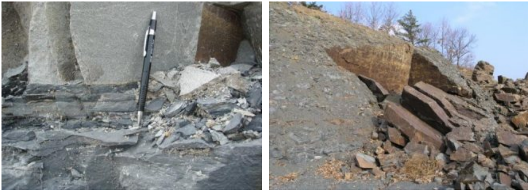
〈그림 3-36〉 층리 및 층리의 미끄러짐에 의한 평면파괴
