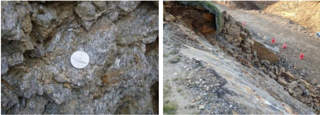
〈그림 3-35〉 엽리 및 엽리면을 따라 발생한 평면파괴
