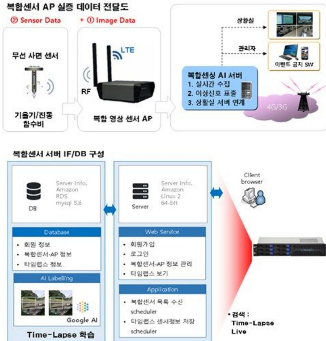
〈부도 3-5〉 복합센서 및 영상AP활용 웹기반 상시계측 시스템 구성도
