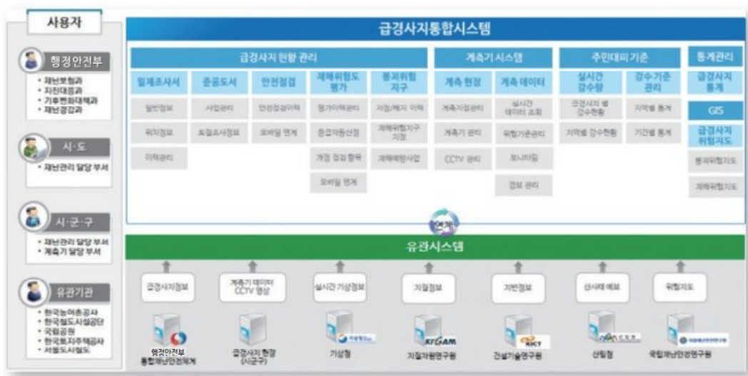
〈그림 10-3〉 NDMS 급경사지통합시스템 시스템 구성도
