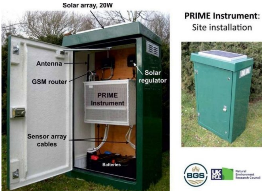
〈부도 2-26〉 영국의 원격 토공구조물 위험도 모니터링 시스템인 PRIME 시스템
