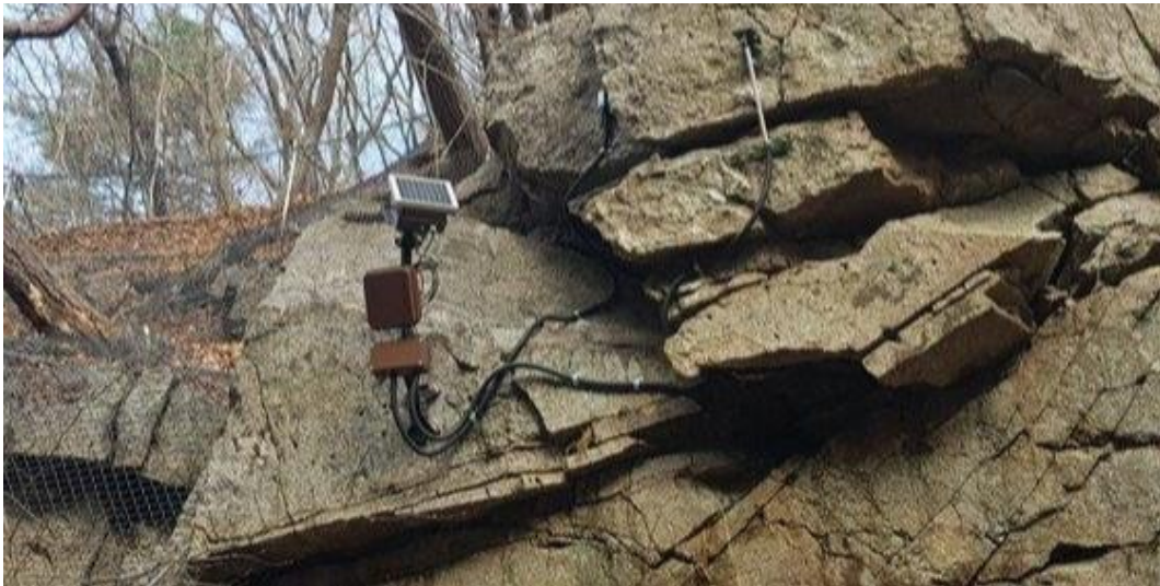
〈부도 2-5〉 낙석 위험지역 대상 계측시스템 설치 사례
