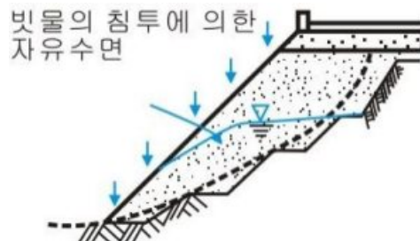
〈그림 3-50〉 깊은 성토 붕괴 : 기반암 상단부 성토부에 활동면이 형성되는 경우
