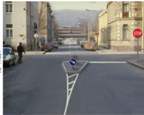
〈그림 3-76〉 주·부도로 구분을 위한 물방울섬 설치 개념도 및 사례 (교통안전공단, 2007)
