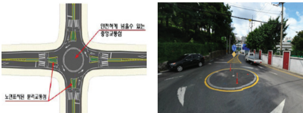
〈그림 3-79〉 초소형 회전교차로 설치 개념도 및 사례1
