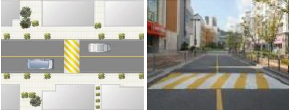
〈그림 3-25〉 범프(bump) 설치 개념도 및 사례
