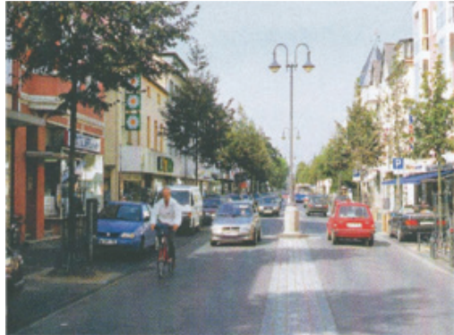
〈그림 3-52〉 상업지역 보행섬 설치 개념도 및 사례 (교통안전공단, 2007)
