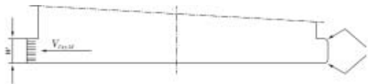
1 파손 모서리 그림 9.5.4 직선 접촉면
