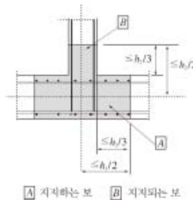
그림 5.10.7 두 개의 보의 교차 영역에 대한 철근의 배치
