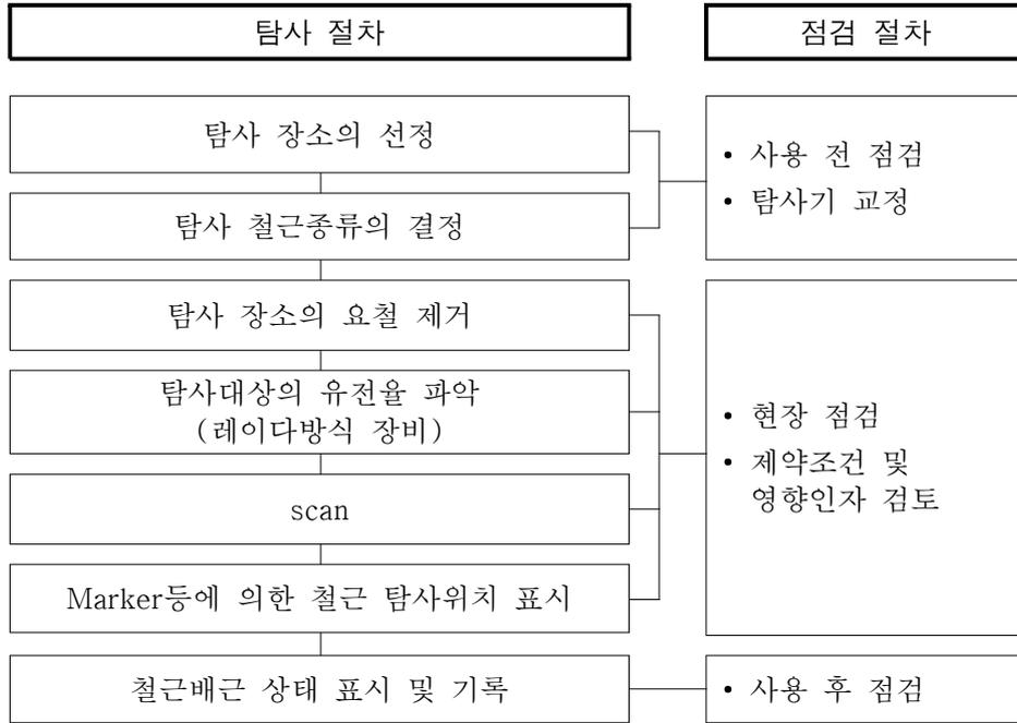
[그림 6.8] 철근탐사 및 장비 점검 등의 절차
