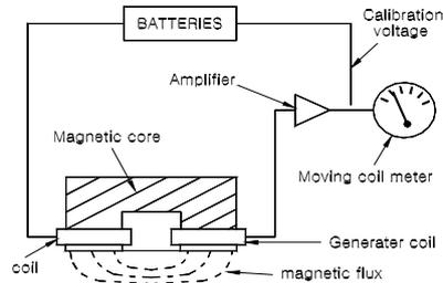
[그림 6.6] 전자기유도 방식에 의한 철근탐사장비의 구성
