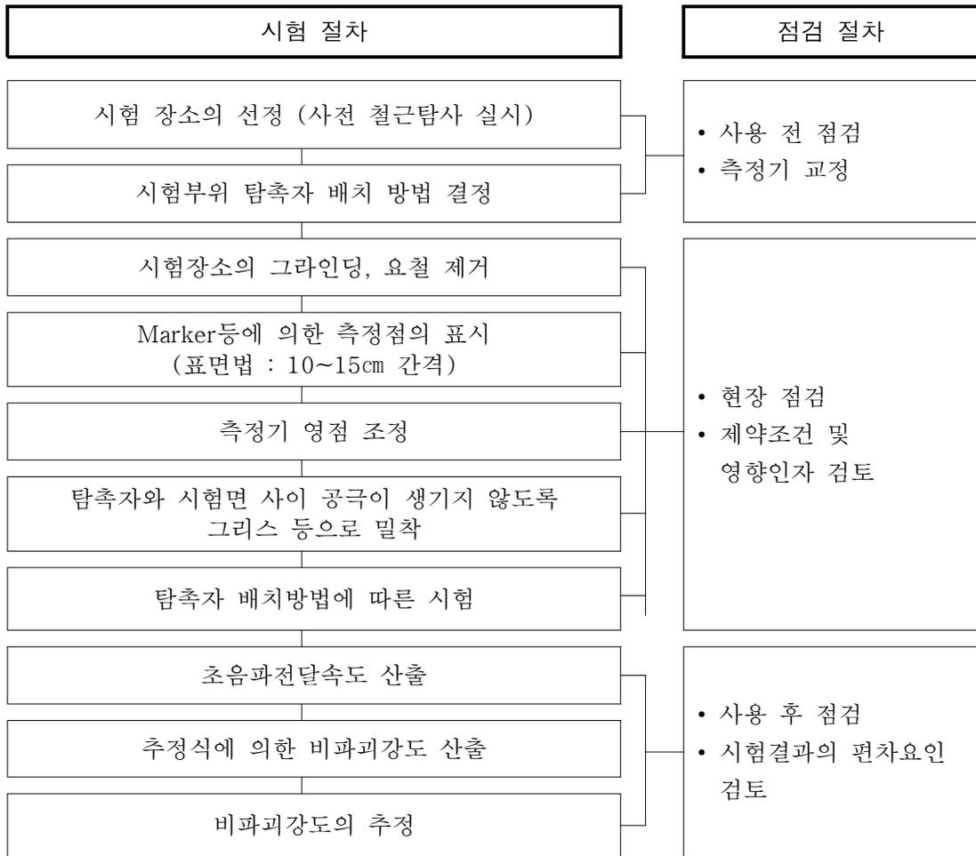
[그림 6.2] 초음파전달속도시험 및 측정기 점검 등의 절차
