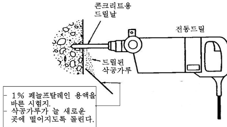
[그림 6.13] 드릴에 의한 탄산화깊이 측정
