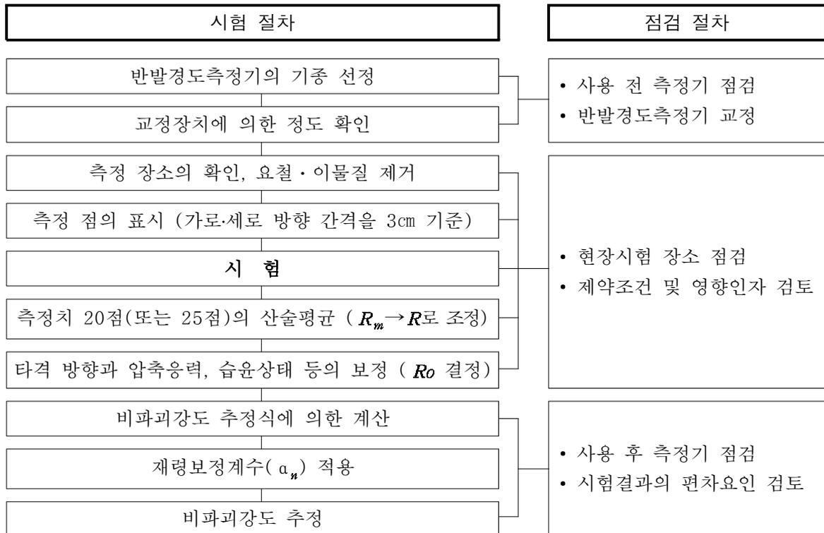
[그림 6.1] 반발경도시험 및 측정기 점검 등의 절차
