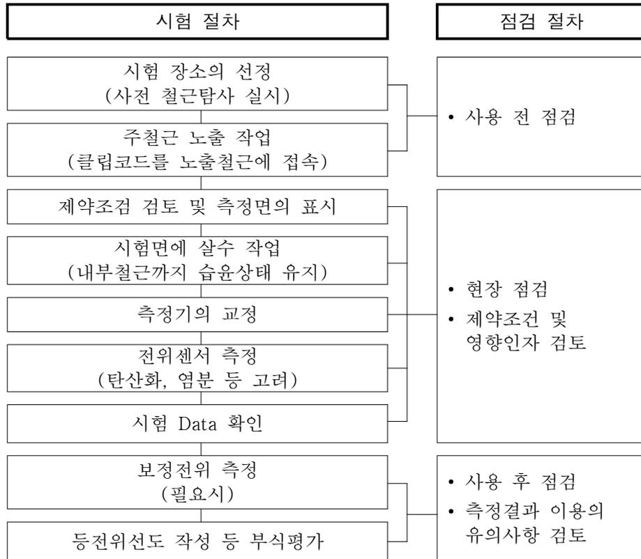
[그림 6.10] 철근부식도시험 및 측정기 점검 등의 절차
