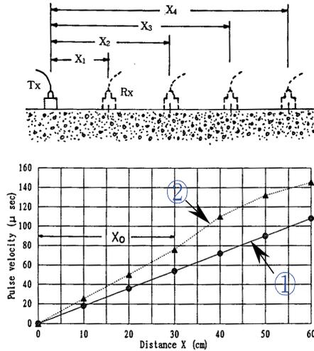
[그림 6.4] 표면법에 의한 초음파전달속도의 측정
