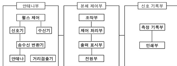
[그림 6.7] 전자파 레이더법에 의한 철근탐사장비의 장치 구성도
