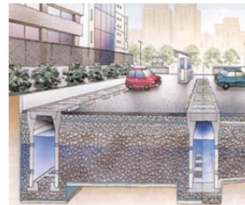
(a) 침투통 및 침투관 조합 설치 모식도: 건물옥상 (b) 침투측구 설치 모식도: 주차장
