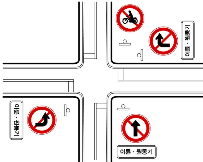
[그림 4-4] 이륜자동차 및 원동기장치 자전거 통행금지(205) 표지 설치 예시도
