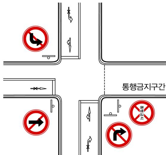
[그림 4-2] 통행금지(201) 표지 설치 예
