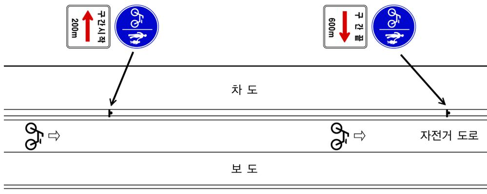
[그림 5-3] 자전거 및 보행자 통행구분(317) 표지 설치 예시도
