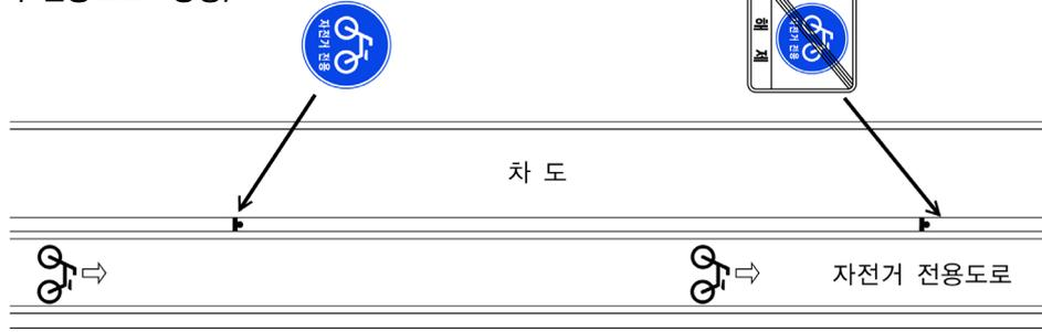
[그림 5-1] 자동차전용도로(301) 및 자전거전용도로(302) 표지 설치 예시도
