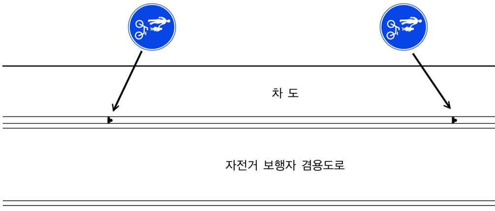
[그림 5-2] 자전거와 보행자 통행을 구분할 필요없는 자전거 및 보행자 겸용도로(303) 표지 설치 예시도
