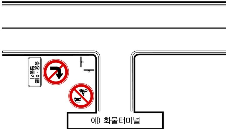
[그림 4-5] 승용자동차, 2륜자동차 및 원동기장치자전거 통행금지(206) 표지 예시도
