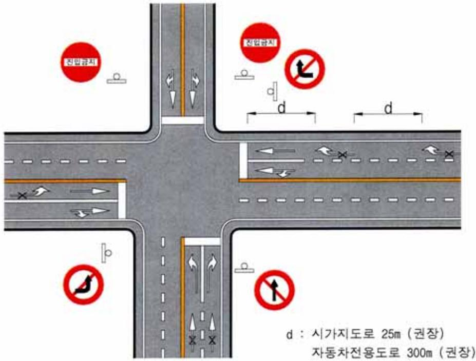
[그림 3-10] 우회전금지(606) 및 좌회전금지(606-1) 표시 설치 예시도
