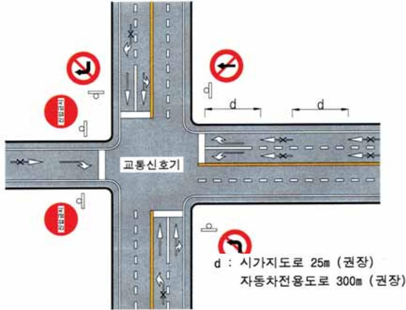
[그림 3-11] 직진금지(607) 표시 설치 예시도
