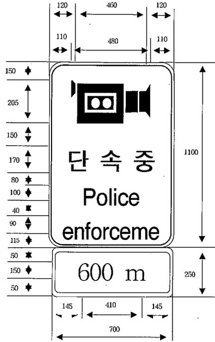
[그림 4.16] 무인 교통단속표지 및 보조표지(예고) 로고·문안 예(기본형)
