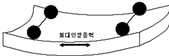
<그림 10.13> 하향균열을 유발하는 컬링 및 차륜하중 재하상태
