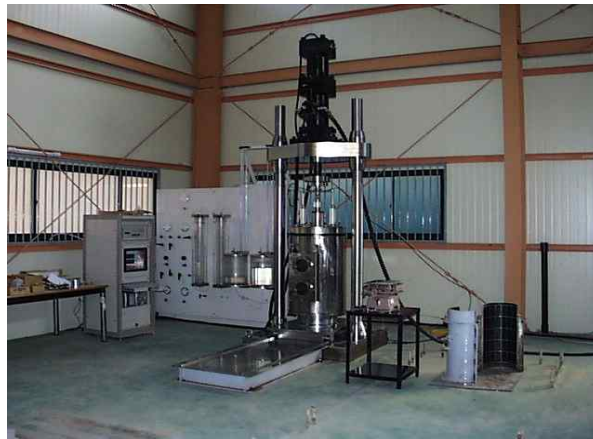
〈그림 11.21〉 대형삼축압축 시험장치 전경
