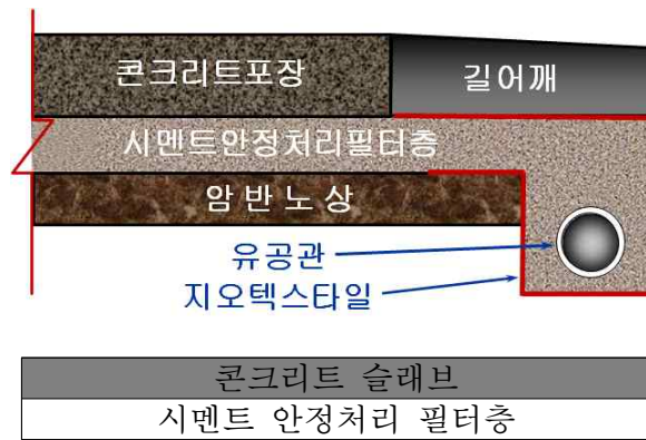
〈그림 1-1〉 암반위의 콘크리트포장 단면
