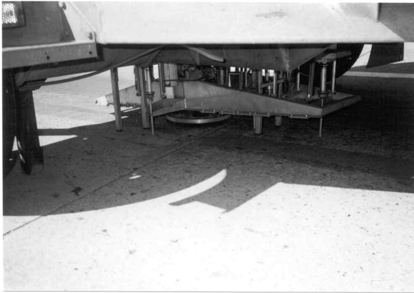
〈그림 7.21〉 줄눈부의 FWD 측정
