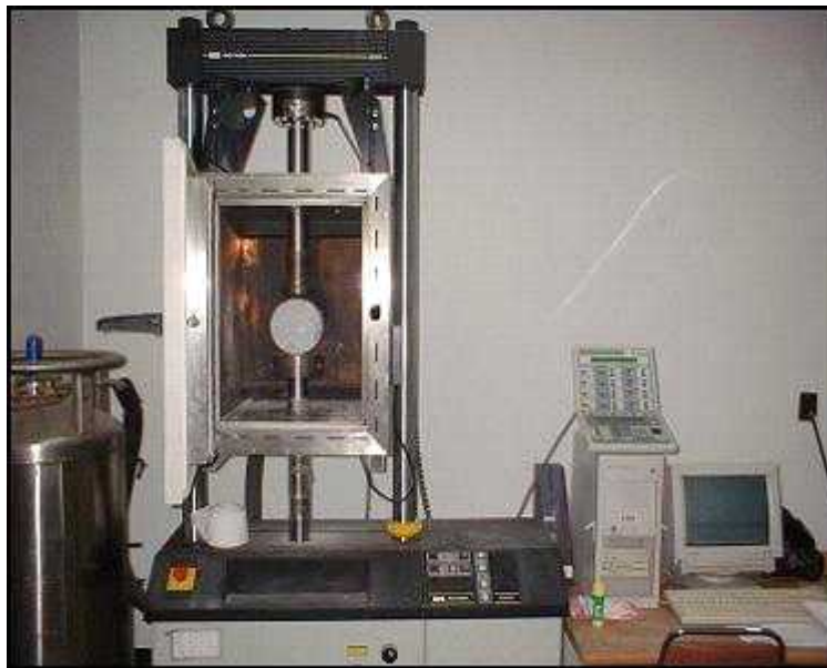
〈그림 11.23〉 쪼갠인장 피로시험에 사용된 시험체 및 실험 장치
