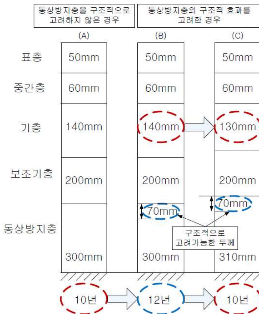
〈그림 17.4〉 동상방지층의 구조적 효과를 고려한 포장 설계 결과
