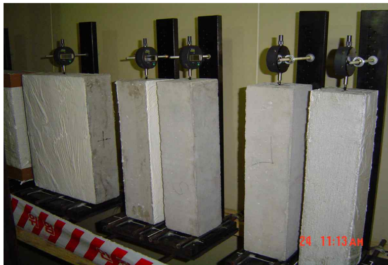
〈그림 7.10〉 다이얼 게이지를 이용한 건조수축 측정 장면
