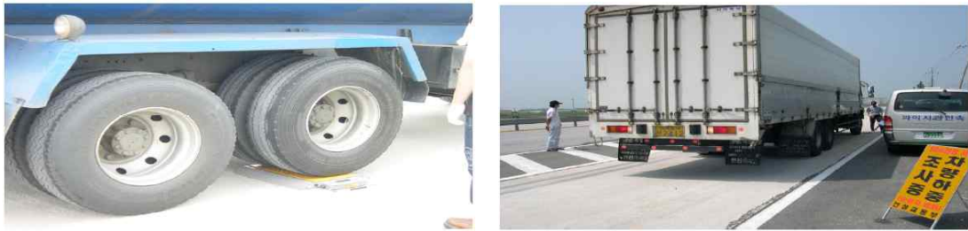
〈그림 1.1〉 축하중 조사방법(이동식 및 검문소)
