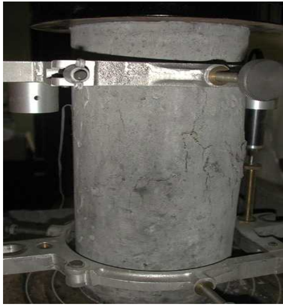
〈그림 7.3〉 콤프레소미터를 이용한 탄성계수 측정
