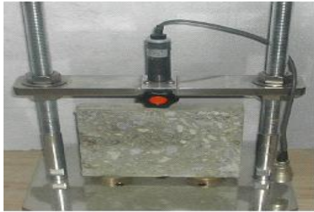
〈그림 7.12〉 열팽창계수 실험 개념도 (LVDT 실험방법)
