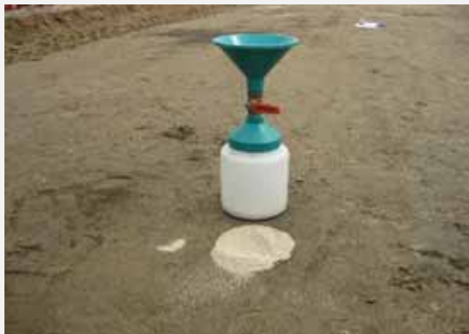
〈그림 4.8〉 현장 다짐도 측정
