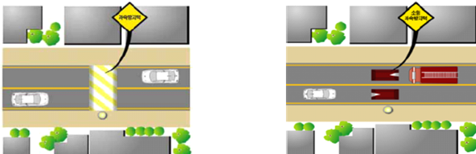
<그림 8-5> 과속방지시설 설치 예시
