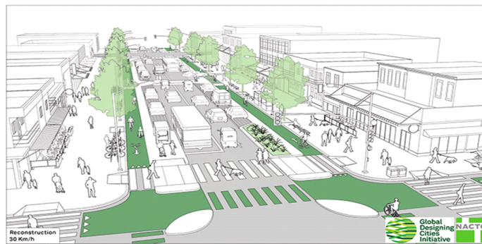
<그림 4-14> 상업지역의 보조간선도로 설계 예시
