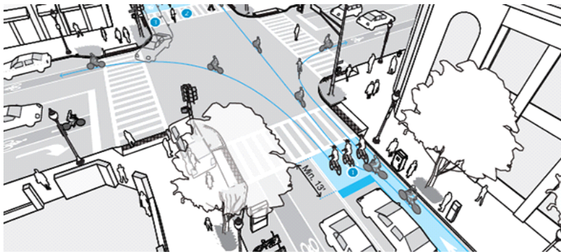
<그림 5-21> 평면교차로 자전거 대기공간(Bicycle Boxes) 설치 예시
