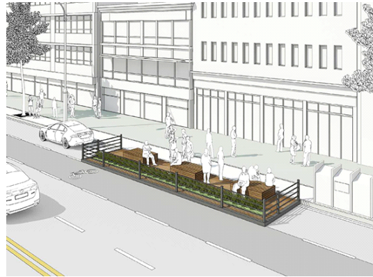
〈그림 6-5〉 도로변 미니공원(파클렛, parklet) 설치 예시
