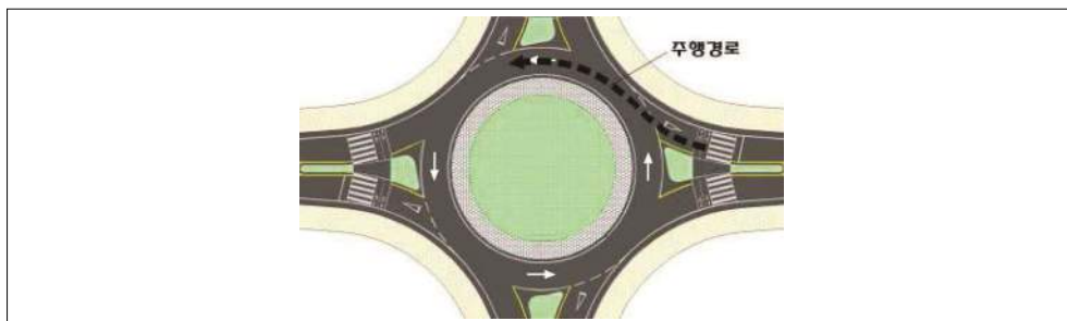
<그림 4.2> 진입로 기하구조를 통한 자동차 주행경로 곡선화
