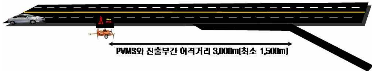
<그림 9> 고속도로 PVMS 설치 지점 예시
