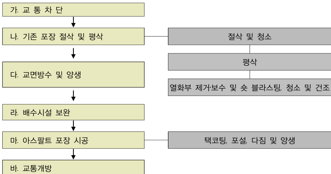
<그림 4.2> 절삭 덧씌우기식 아스팔트 콘크리트 교면포장 시공절차
