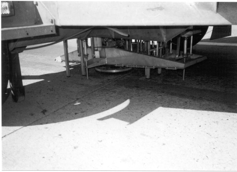
&lt;그림 7.21&gt; 줄눈부의 FWD 측정
