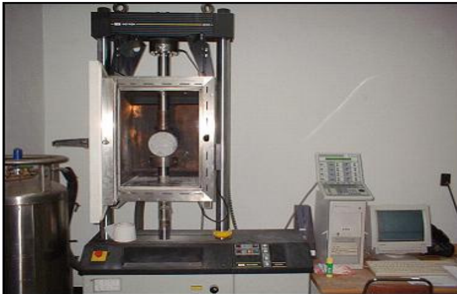
&lt;그림 11.23&gt; 조갸인장 피로실험에 사용된 시험체 및 실험 장치
