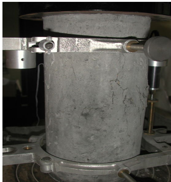
<그림 7.3> 콤프레소미터를 이용한 탄성계수 측정
