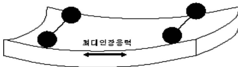
<그림 10.13> 하향균열을 유발하는 컬링 및 차륜하중 재하상태
