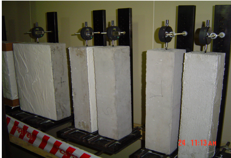
<그림 7.10> 다이얼 게이지를 이용한 건조수축 측정 장면
