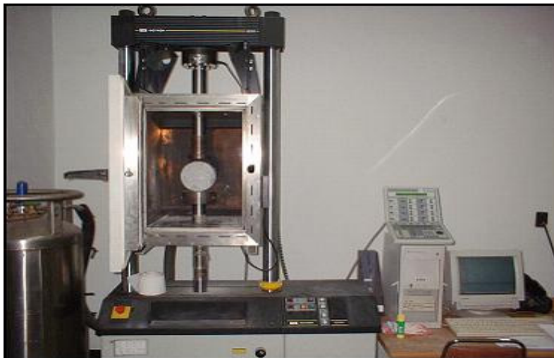
〈그림 9.23〉 조개인장 피로실험에 사용된 시험체 및 실험 장치
