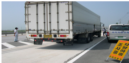
〈그림 3.1〉 축하중 조사방법(이동식 및 검문소)
