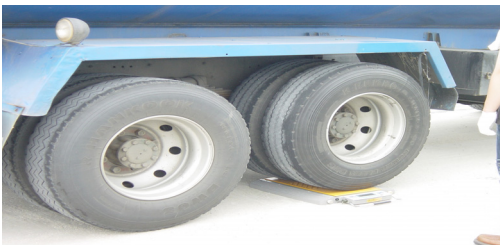
〈그림 3.1〉 축하중 조사방법(이동식 및 검문소)
