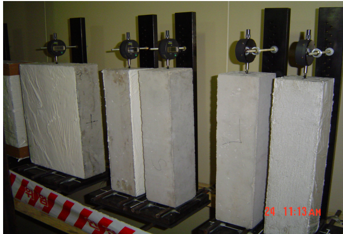
〈그림 7.10〉 다이얼 게이지를 이용한 건조수축 측정 장면
