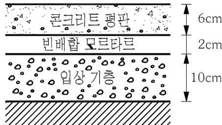
〈그림 6.5〉 보도용 콘크리트 평판 포장에 따른 표준 단면
