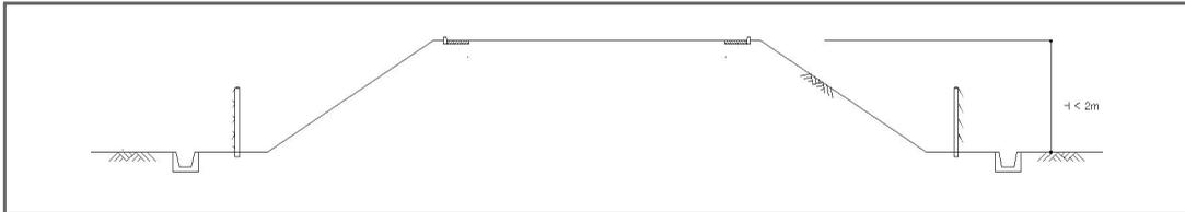
〈그림 5.8〉 흙쌓기부(H<2.0m) 울타리 설치 개념도
