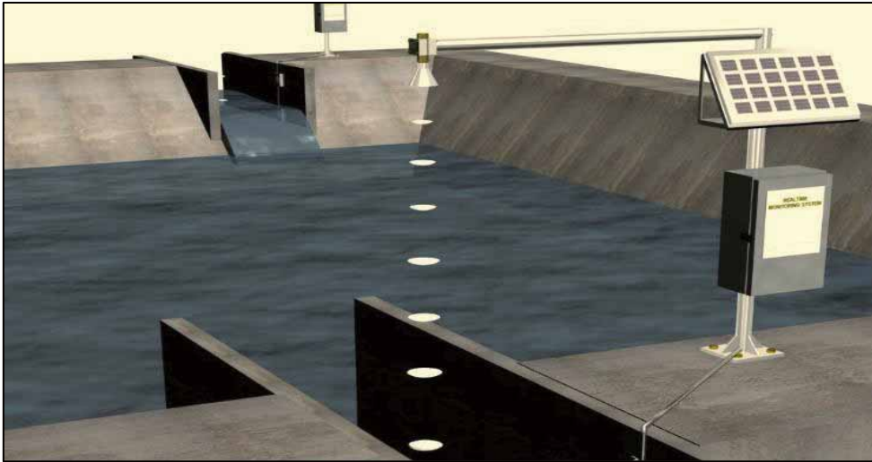
<그림 3-16> 레이더 수위계를 이용한 저류시설 수위 모니터링
