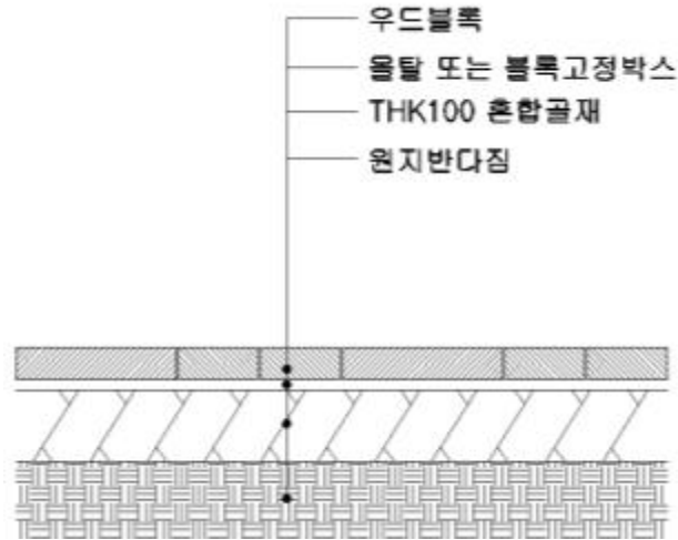
〈그림 7-8〉 우드블록 포장 단면
