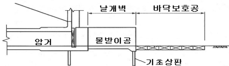
&lt;그림4.1-7&gt; 수문·수로의 바닥보호공 설치 사례
