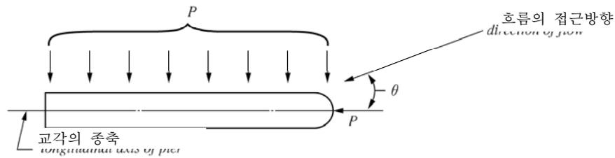
그림 4.9.1 동수압을 보여 주는 교각의 평면도
