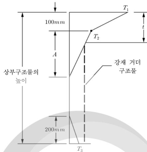
그림 4.11-1 콘크리트와 강재상부구조물에 발생하는 온도의 수직변화곡선
