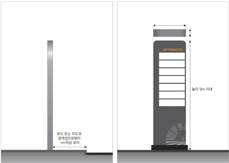
지주형 광고물의 설치 및 배치
