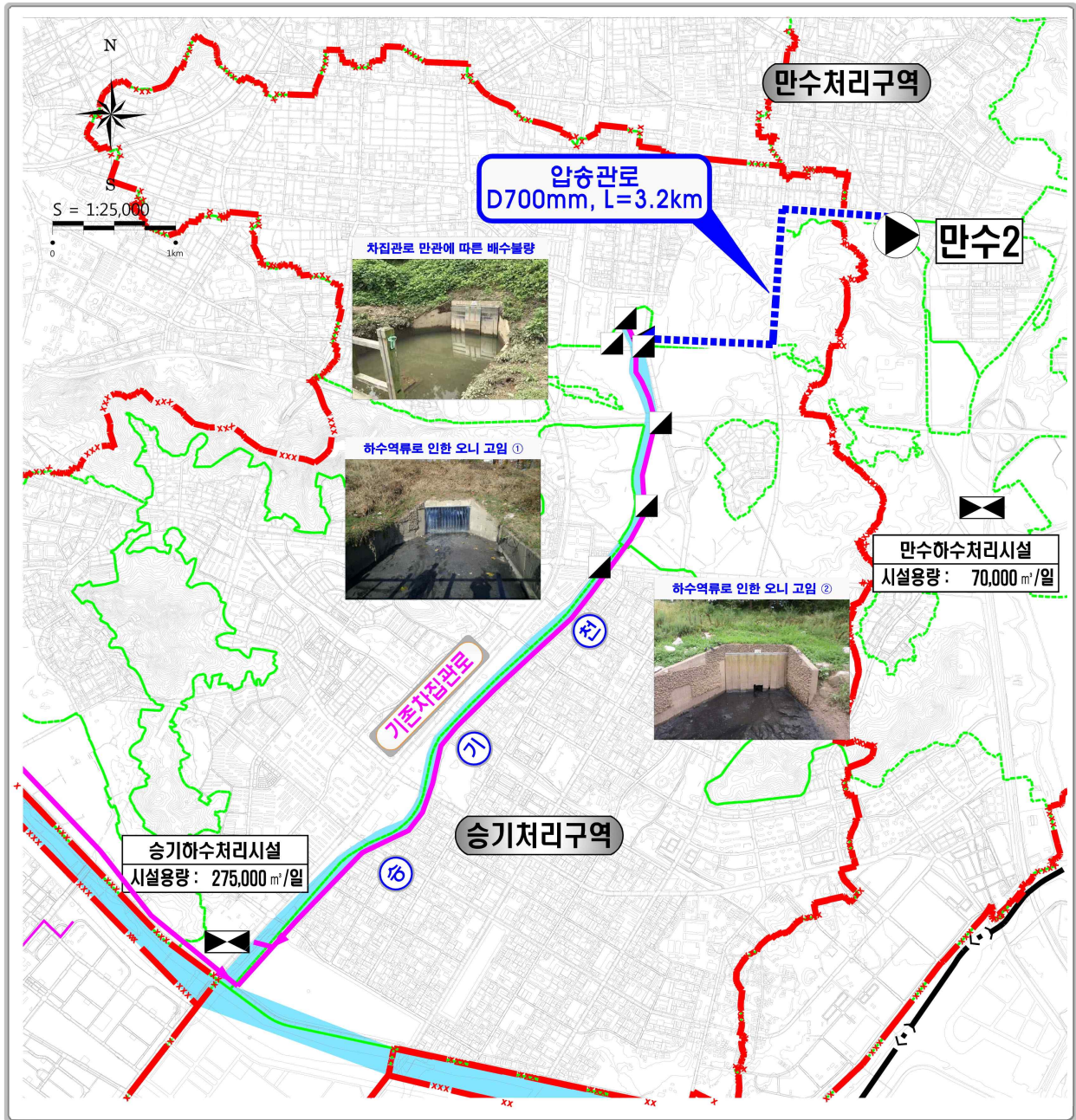
<그림 3.2-3> 승기공공하수처리시설 이송처리 및 분뇨 역류 현황
