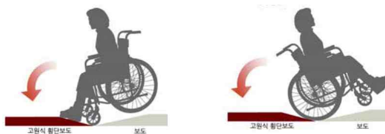
[그림 4.28] 보도와 고원식 횡단보도의 부적절한 경사면 연결
